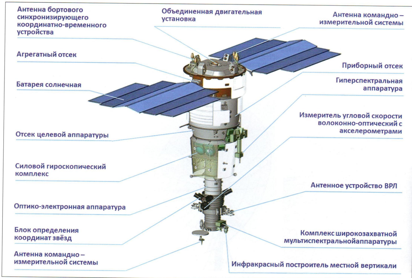
Рис. 1. Внешний облик КА «Ресурс-П» №1
